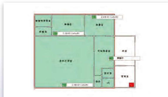
建屋平面図(オプション) 放射線施設に設置された放射線モニタの状況を表示。
